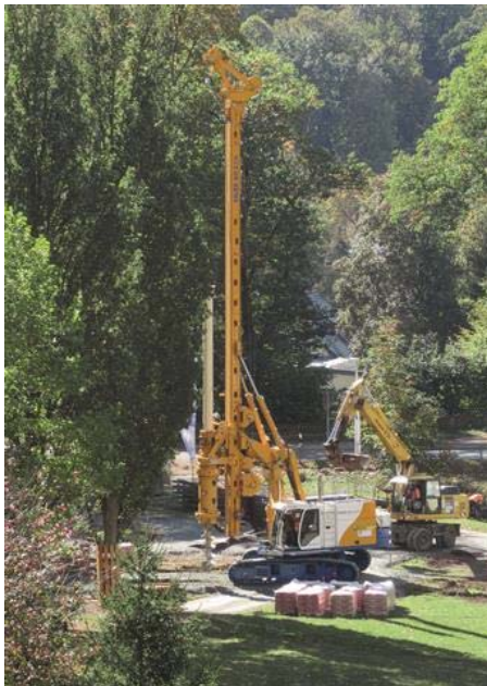
(1) Die BAUER BG 23 H wird auf einem neuen Trägergerät und ausgerüstet mit H-Kinematik zu sehen sein.
